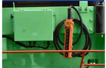
オペレータは機体より離れ、切削面を監視しながら正確な切削作業ができます。
